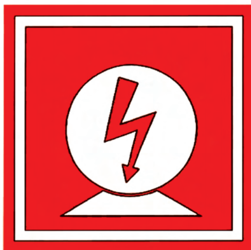
d) Zdroj elektrické energie
